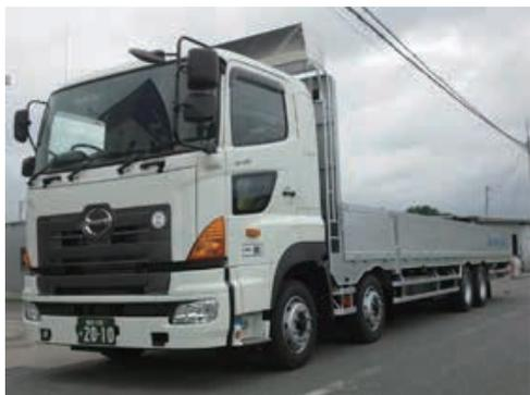
総輪エアサス低床車で、長距離・中距離貨物の輸送をしています。
